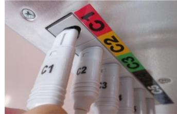
Saugleitungen am Verteiler entsprechend den Codierungen und Kennzeichnungen einstecken.
