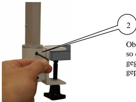
Oberen Gewindestift (M6x6) festdrehen, so dass das Fußende des Tragarms fest gegen die Hülse der Tischhalterung gepresst wird.
